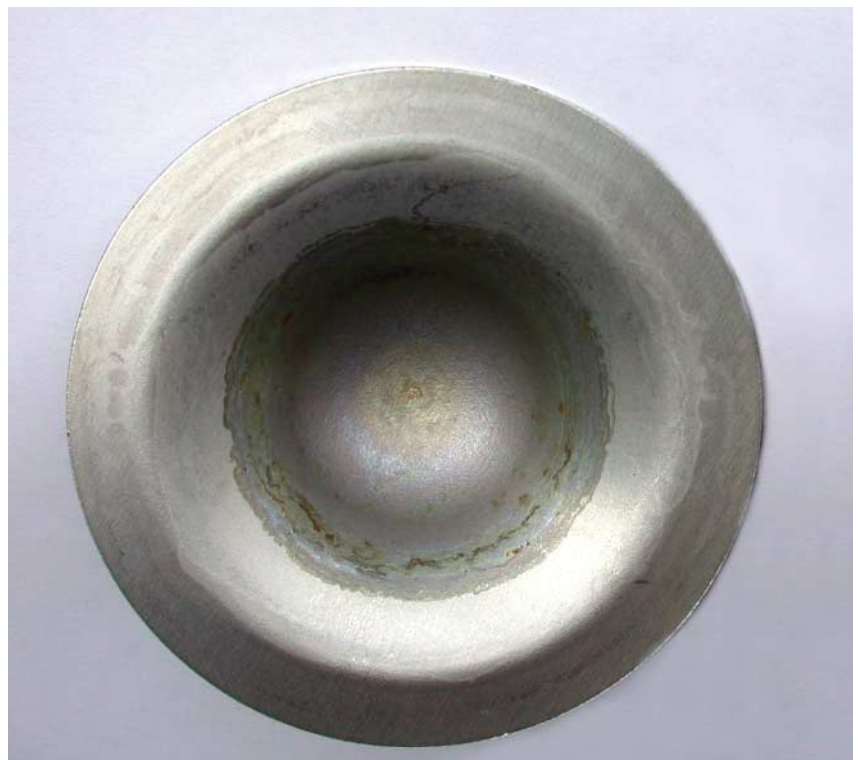
Bild 2: Ansichtsaufnahme einer tiefgezogenen Probe (Kalotte) Figure 2: View of a deep-drawn specimen
