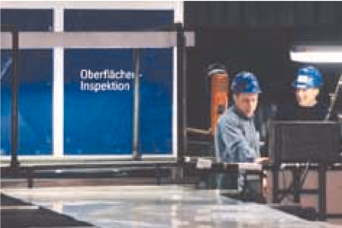
Automatische Oberflächeninspektion in einer Kaltbandlinie.
