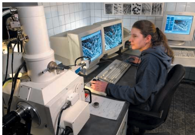
Rasterelektronenmikroskop für anspruchsvolle Werkstoffuntersuchungen.
